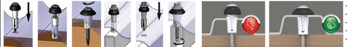
Šroub s gumovou podložkou je nutné utahovat příměřeně (nesmí být nedotažený – podložka se volně otáčí, nebo přetažený – kraje podložky se zvedají), jinak může dojít k netěsnostem.
